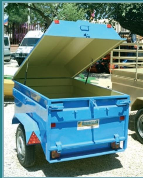
Tapa metálica con amortiguadores de gas.
